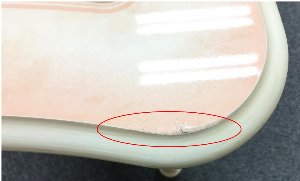
天板に塗装のはがれあり
