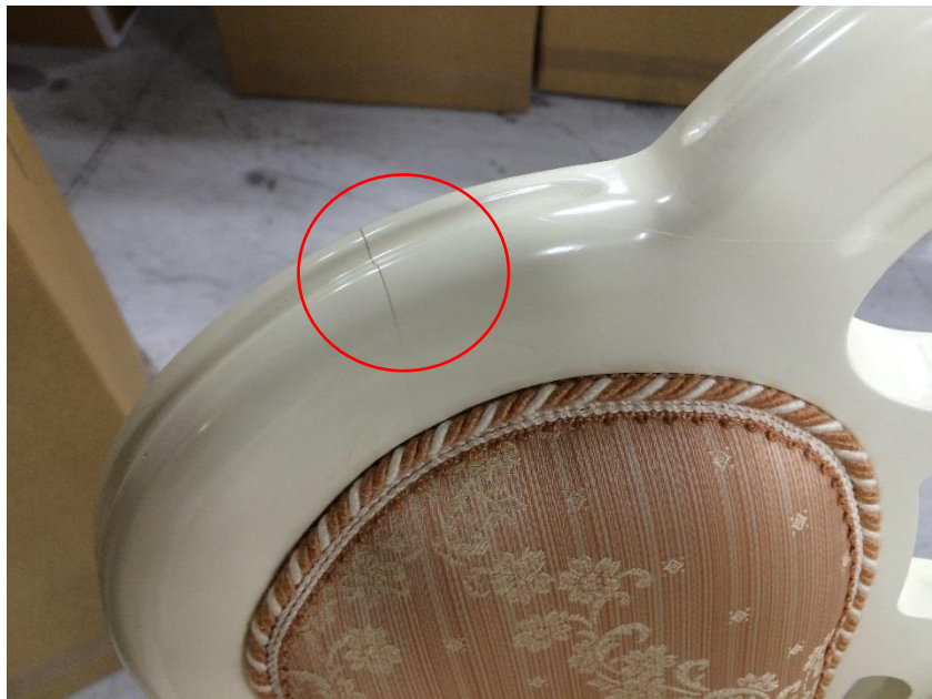
№4 つなぎ目に塗装割れあり
