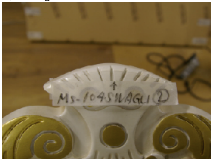
正面トップ装飾部分に筋あり
